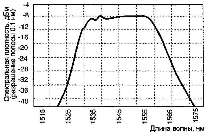
Рис. 7.3. Зависимость коэффициента усиления EDFA от длины волны
