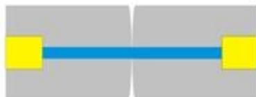
Рис. 6.19. Торцы оптических волокон без полировки
