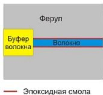
Рис. 6.18. Оптический разъем
