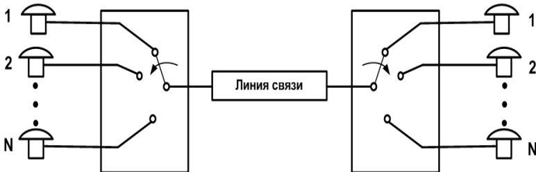
Рисунок 1.4. – Принцип временного разделения каналов
