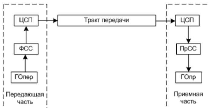
Рисунок 3.19. – Передача цикловой синхронизации в ЦСП
