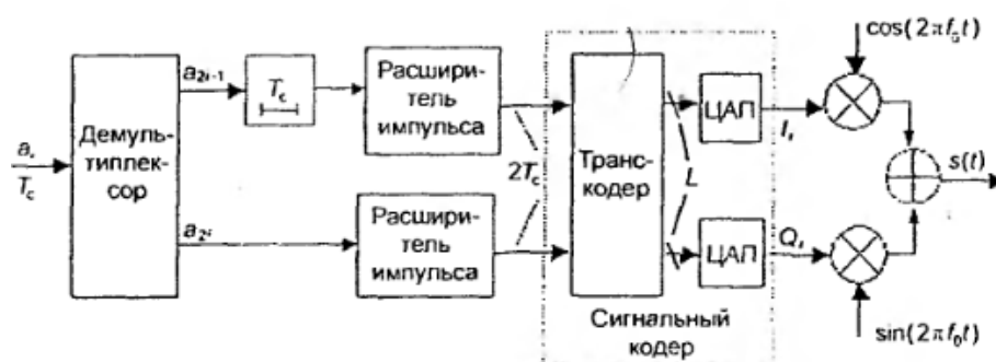
Рис. 10.9. Функциональная схема устройства формирования радиосигнала с \pi/4 -квадратурной ОФМ
