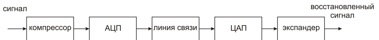
Рис. 5.7. Схема преобразования при использовании компрессора и экспандера
