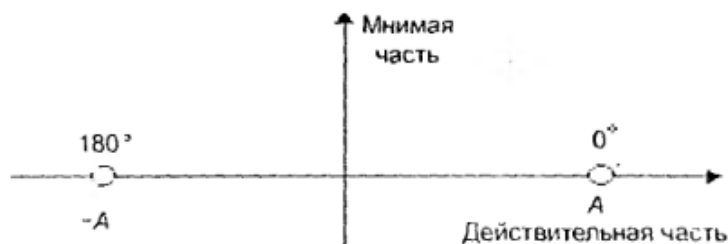
Рис. 10.2. Сигнальное созвездие ФМ-2
