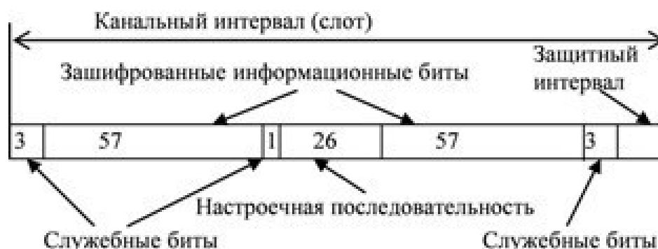
Рис.1.10. Структура канального интервала стандарта GSM
