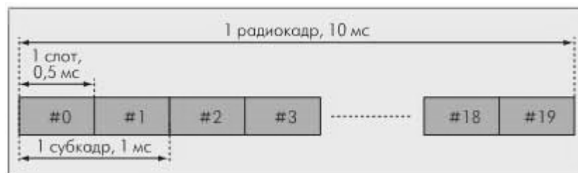
Рис. 15.2. Структура кадра LTE при частотном разделении дуплексных каналов
