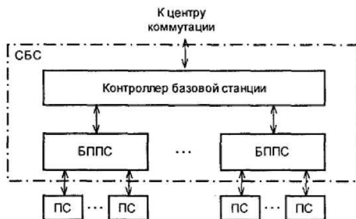
Рис. 9.3. Система базовой станции стандарта GSM
