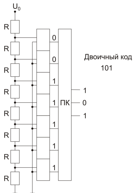
Рис. 5.3. Структурная схема АЦП параллельного типа
